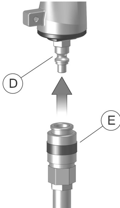
Collegare la marcatrice al tubo dell'aria compressa (E) tramite l'attacco rapido (D) posto nella parte inferiore della marcatrice (vedi figura). Durante l'utilizzo della marcatrice è importante assicurarsi che la pressione dell'aria di alimentazione non scenda mai al di sotto dei 5 bar e non superi gli 8 bar. Usare soltanto aria filtrata e lubrificata; l'uso di qualsiasi altra alimentazione come gas combustibili o gas compressi può provocare esplosioni con conseguenti danni alle persone.
