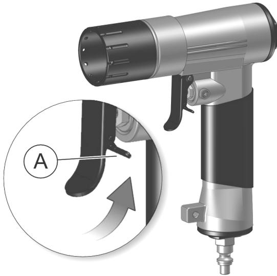
Prima di procedere a qualsiasi operazione di sostituzione dei punzoni, collegamento o scollegamento dal circuito di alimentazione e comunque prima di effettuare qualsiasi intervento di manutenzione sulla marcatrice assicurarsi di avere inserito il dispositivo di sicurezza. Per inserire la sicurezza ruotare la sicura (A) verso l'alto (vedi figura) fino al bloccaggio del grilletto.
